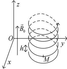
$$\text{Pas } h \text{ de l'hélice : } h = v_{0z} T = v_{0z} \frac{2\pi m}{|qB_0|}$$
