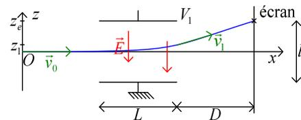
On envoie un faisceau homocinétique (avec la même vitesse) d'électrons sur l'axe  $(Ox)$  avec une vitesse initiale  $\vec{v}_0 = v_0 \vec{i}$ .
