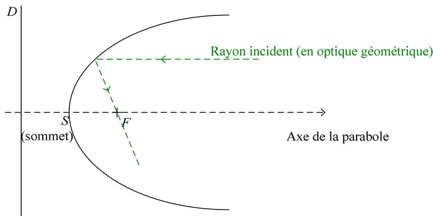
$F$  est l'image, rigoureusement stigmatique, d'un faisceau de lumière incident parallèle à l'axe de la parabole.
