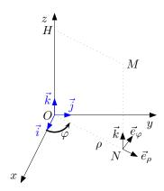
$(\vec{e}_{\rho}, \vec{e}_{\varphi}, \vec{k})$  est une base locale (elle dépend de M à cause de  $\rho$  et  $\varphi$ )
