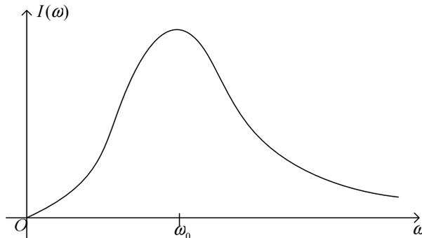
On a donc une résonance d'intensité en  $\omega = \omega_0$
