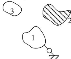
Le déplacement de 2 ne se fera pas à charge constante pour le conducteur 1, puisque lorsque 2 va bouger, le potentiel va changer et il y aura un échange de charge. 3 et 2 resteront eux à charge constante.
